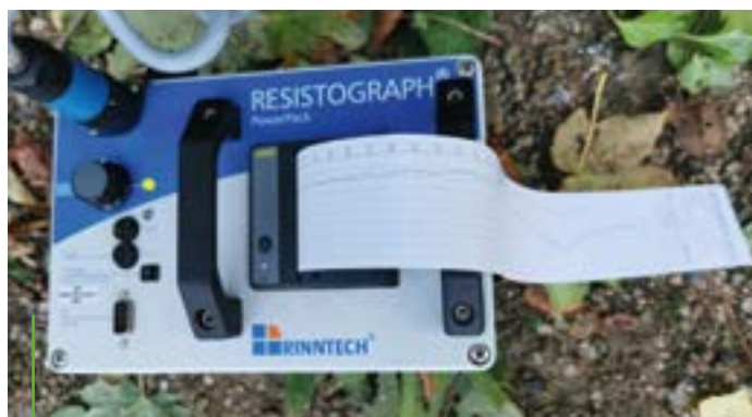
Der Resistograph ist ein Holzwiderstandsmessgerät, welches insbesondere bei abgängigen Bäumen zur Prüfung der Restwandstärke eingesetzt wird.
